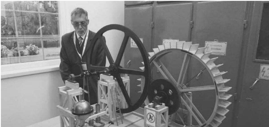
A Tumler-féle vízemelő szerkezetet mutatja be az a makett, melyet Póta László készített
